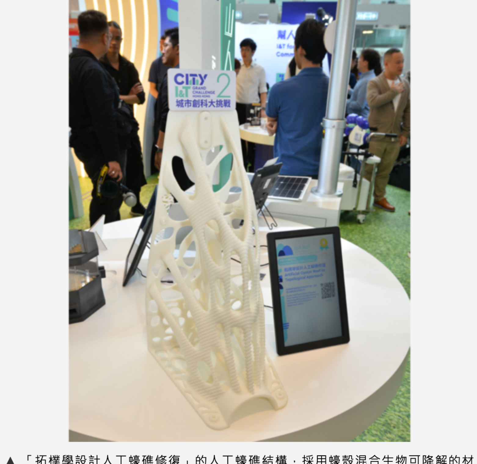
▲ 「拓樸學設計人工蠔礁修復」的人工蠔礁結構，採用蠔殼混合生物可降解的材料，再利用3D打印技術製造。
