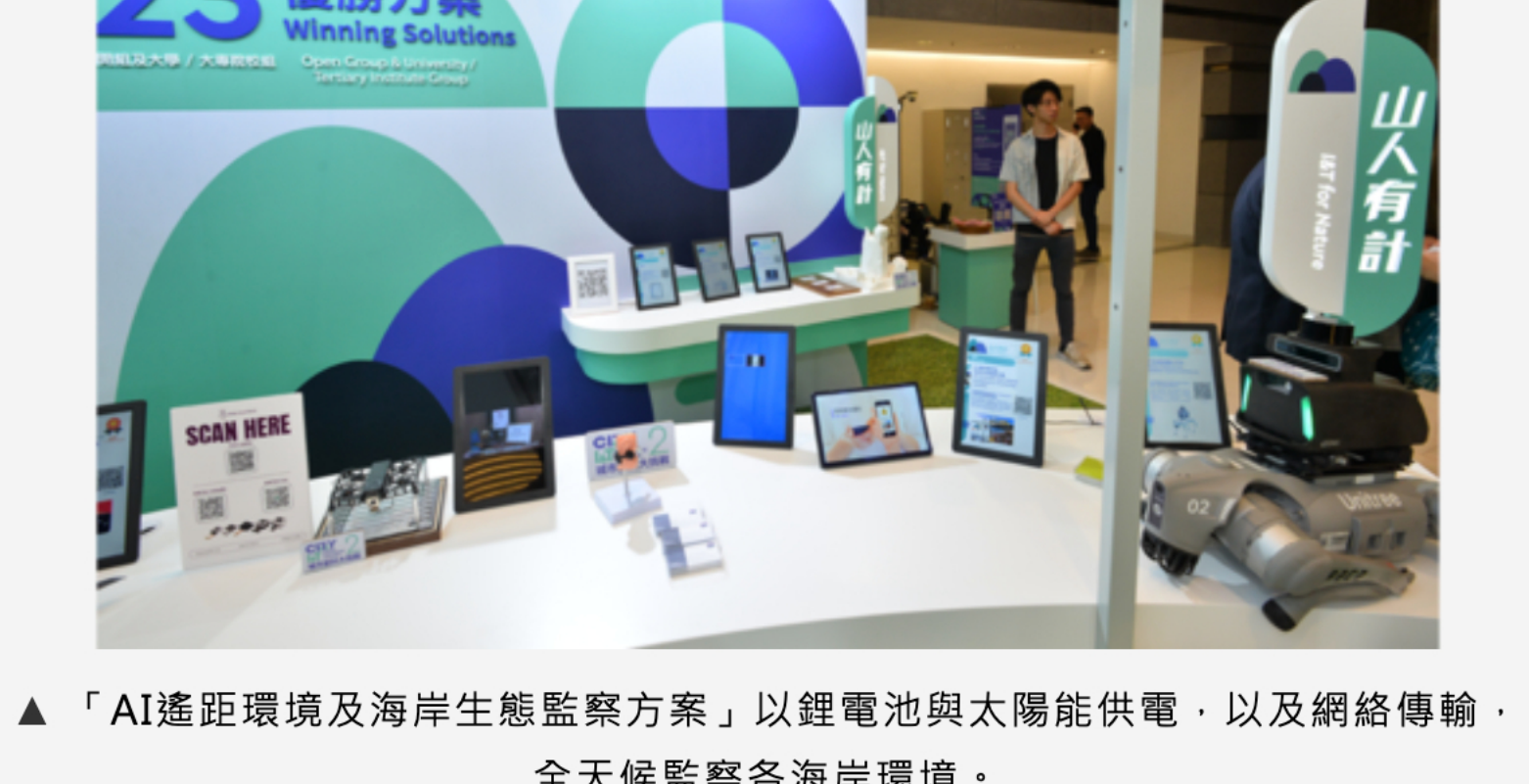
▲ 「AI遙距環境及海岸生態監察方案」以鋰電池與太陽能供電，以及網絡傳輸，全天候監察各海岸環境。
