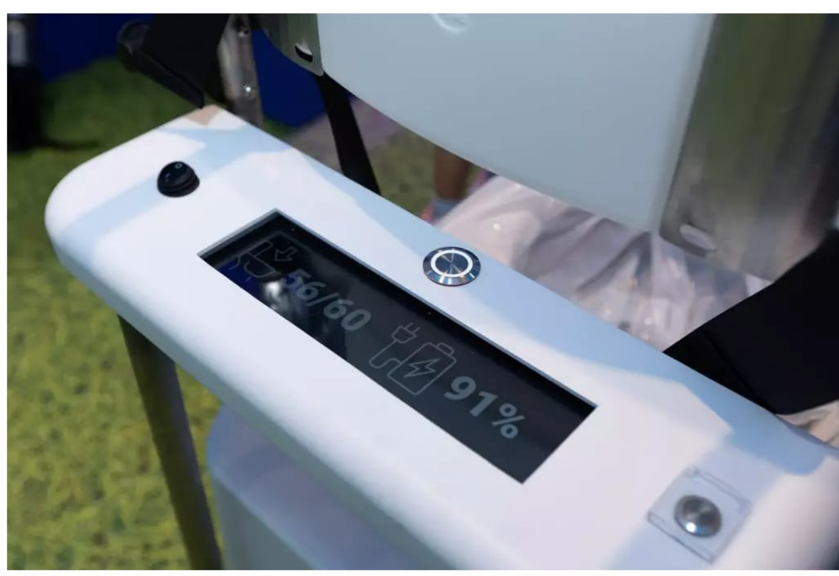
「智能防感染流動乾廁」配備電子屏幕，能夠顯示電量及環保坐墊便盆袋的使用量
